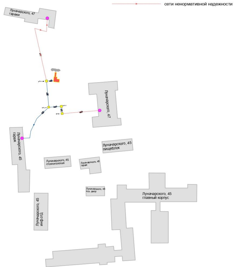
Рис.23. Сети ненормативной надежности котельной ул. Луначарского, 47 ГВС.
